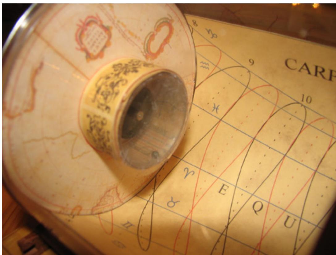
Detalle del cubículo con su bola con escala interior de latitudes para poder rotarlo según la latitud.
