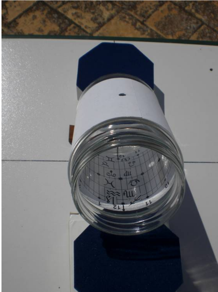
VISTA PARCIAL DESDE EL NORTE DE LA RED DE LÍNEAS MONTADA EN UN BOTE DE VIDRIO DE EJE NORTE - SUR DE 80 mm DE DIÁMETRO. EL DÍA 9 DE SEPTIEMBRE. EL EJE DEL CILINDRO SE ENCUENTRA GIRADO RESPECTO AL ZENITH EL ÁNGULO DE LATITUD DE 39,5°
