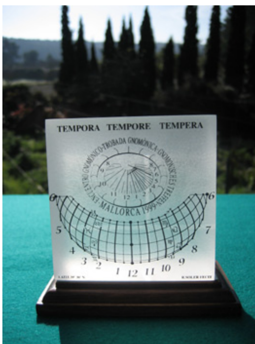
Cuadrante ortomeridiano vertical de refracción auto orientable con gnómones lineales vertical y horizontal (punto definido por una cruz) en forma de franjas pulidas en cara vertical de incidencia del sol matizada y cara opuesta paralela matizada con campos de líneas de declinación y horarias. Las rayas de luz refractadas marcan cerca de las 10 3/4 h a mediados de acuario. Construido para los asistentes al encuentro gnomónico internacional de Mallorca de 1999 auspiciado por la SCG y la AARS.
