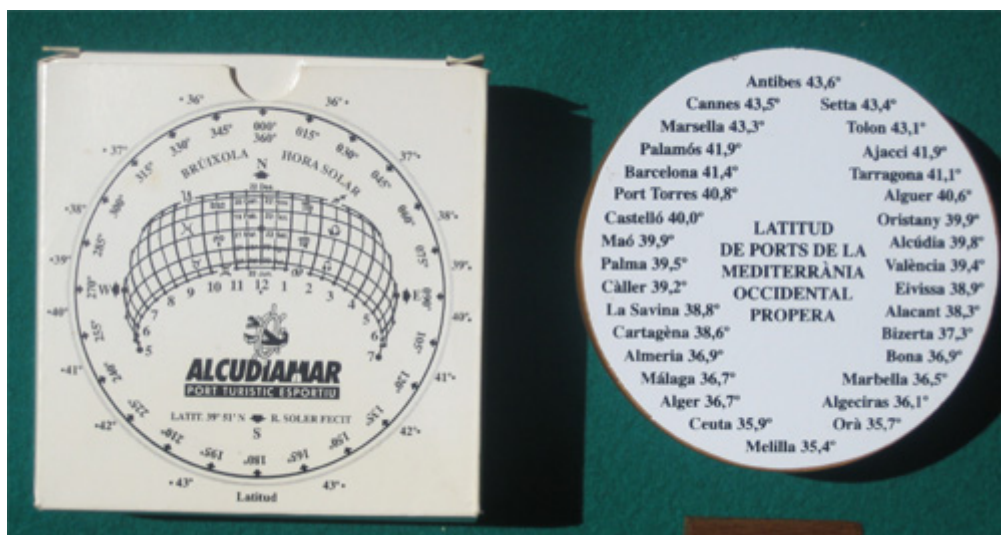
Caja, cuña y reverso del soporte de base curva del cuadrante anterior con las latitudes de puertos del Mediterráneo Occidental.
