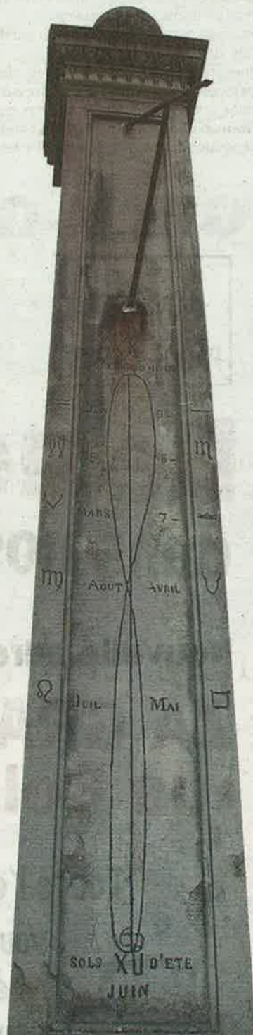
La méridienne de Rioz. Beaucoup de cadrans de ce type sont encore visibles dans le département. Ils permettent une lecture précise de l'heure autour de midi.
