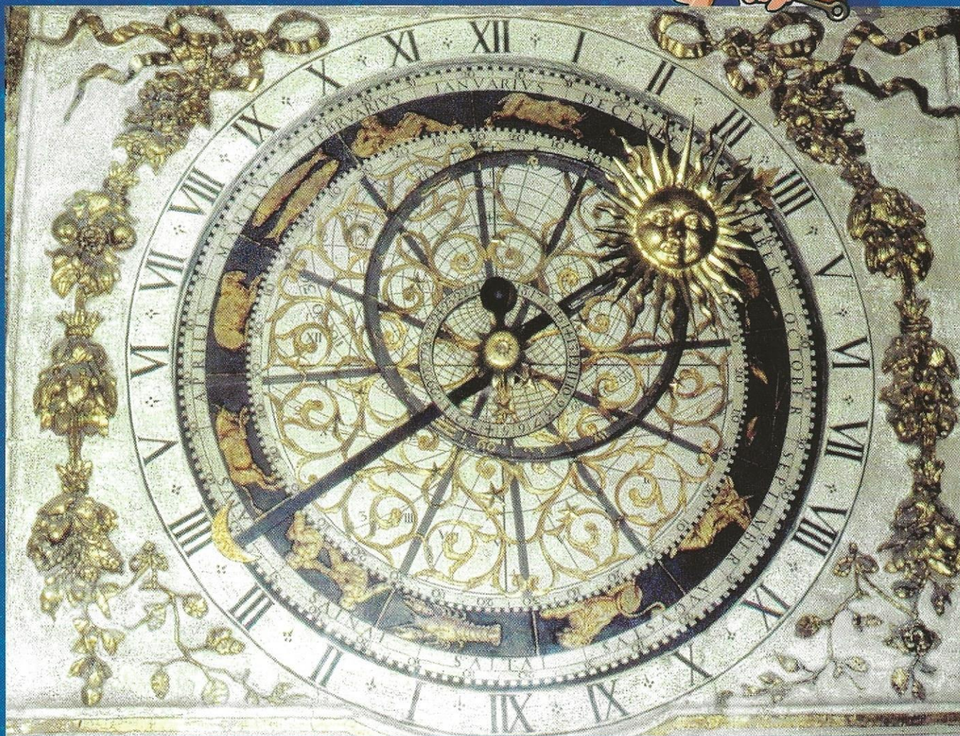
Fig. 1. L'horloge astrolabe de la cathédrale St Jean à Lyon ne comporte qu'une seule aiguille pour lire l'heure et un cadran gradué en 24 parties, exactement comme le cadran solaire que nous vous proposons de construire. On y trouve aussi de nombreux autres renseignements comme par exemple la position de la Lune ou des principales étoiles (photo Charles Henri Eyraud).
