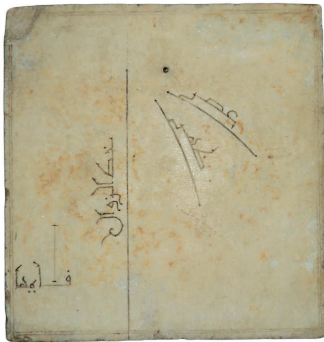
Un cadran solaire est un instrument qui indique l'heure solaire suite au déplacement de l'ombre du gnomon, sur une surface graduée, au cours de la journée. Ici, le cadran solaire du Musée de Tlemcen.
