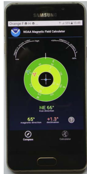
Application compass NOAA sur smartphone avec indication N magnétique/N géographique
